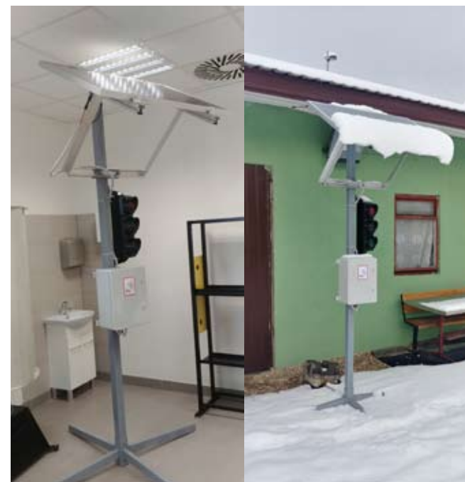
► Model sygnalizatora zasilanego autonomiczną instalacją fotowoltaiczną.
